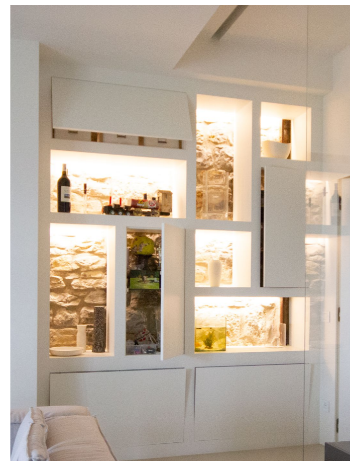
Fantasmino ad un'anta in MDF con diverse tipologie di apertura: battente verticale, vasistas o ribalta con apertura orizzontale e inserimento braccetti snodati per frizionare l'apertura dell'anta. Fantasmino with one MDF door with different types of opening: vertically hinged, vasistas or flap with horizontal opening and insertion of articulated arms to friction the door opening.
